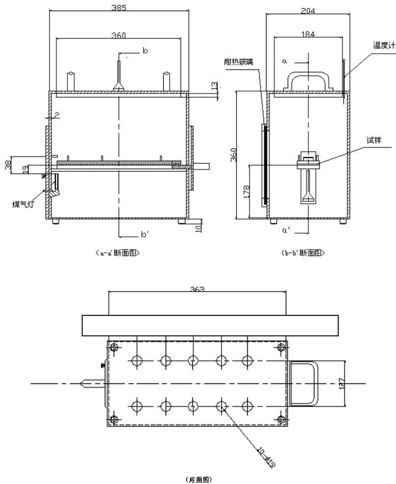
图 2 燃烧箱尺寸示意图
